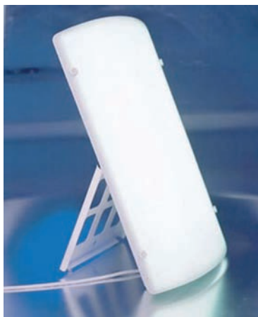
Lampe équipée de deux tubes fluorescents de 80 Watt. Se pose sur une table ou se fixe au mur. Eclairage : 10 000 lux à 50 cm, 5 000 lux à 75 cm.
